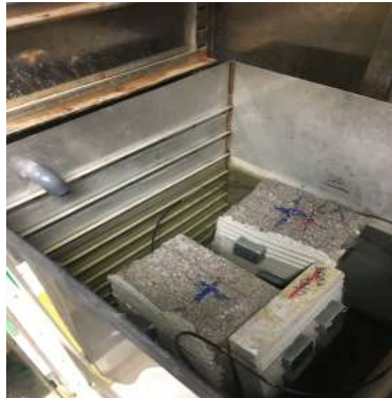
Figur 5.6 a och b. I figur (a) illustreras temperaturen som funktion av tiden för frys- töcykler under ett dygn. Två cykler utförs alltid under ett dygn. Figur (b) visar två lättbetongblock och betongplatta nedsänkt i vatten i frostskaåp under upptiningscykel. Svart kabel är injuten i ett naturstensmaterial för kontroll av temperatur.
