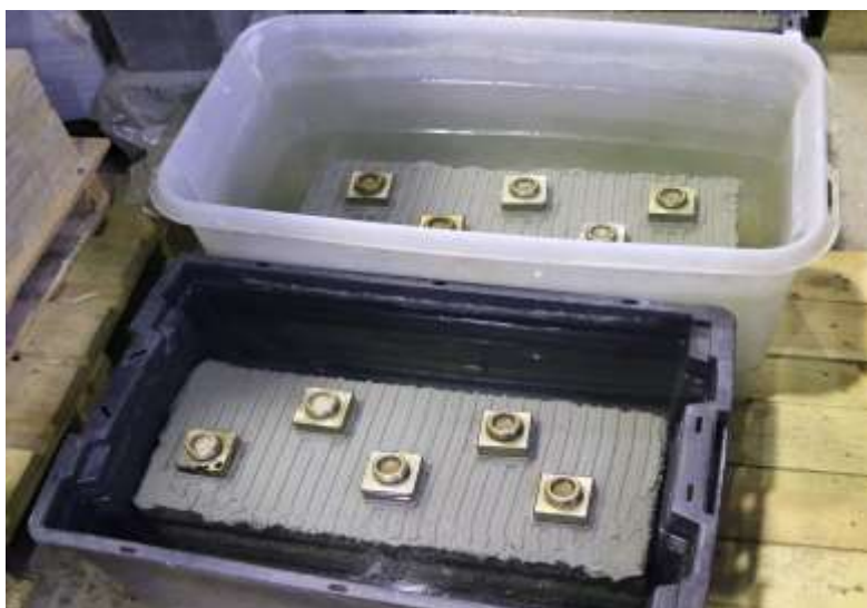
Figur 4.2. Prover med provklackar i vatten inför provdragning. Dragklackar monteras de sista 24h inför provdragning. Proverna ligger i vatten i ca 20 dygn innan provningen utförs.
