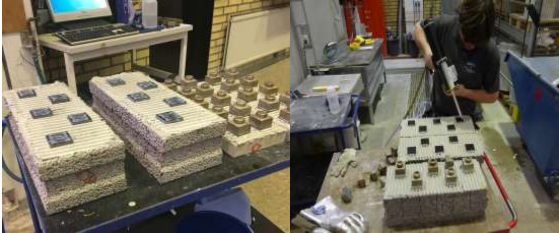
Figure 5.4a, b från vänster till höger. I figur (a) visas limmet påfört utan dragklack på diabas. I figur (b) påförs limmet på ytan med lufttrycksbaserad limpistol.
