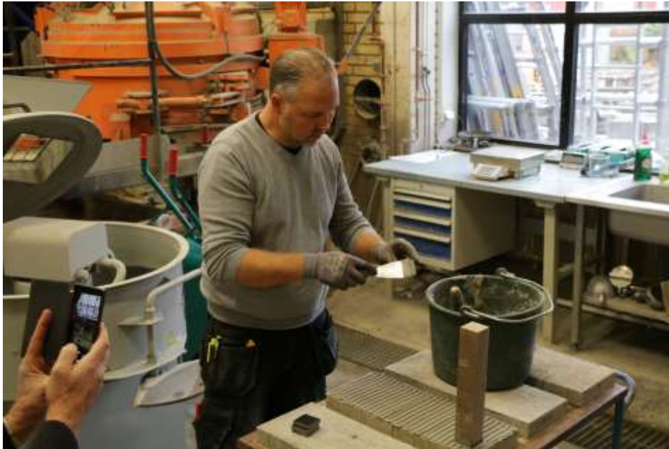
Figur 5.2. Montering av diabas mot underlaget betong. Mikael Medin, Närkesten, stryker på fästmassa mot en ny provkropp innan ansättning mot underlaget. I nedre del av bild har en last om 2 kg (naturstensprisma) påförts det första provet som är lagt i fästmassan.
