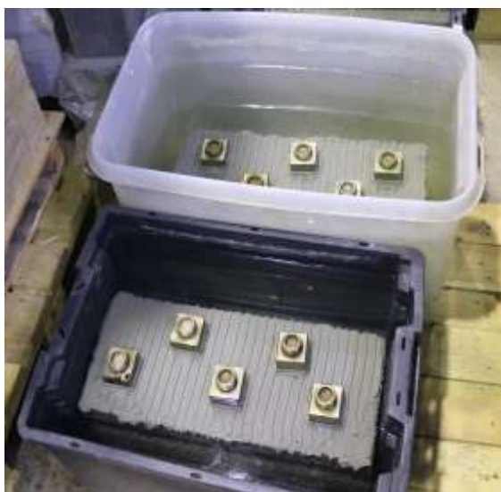
Figur 5.8 a och b. Figur (a) visar Kalksten Norrvange i vattenbad med underlag av betong. Figur (b) illustrerar proverna med underlag lättklinkerbetongblock strax innan provdragning skall utföras med monterade dragklackar. . Vattenlagring utfördes i plastbehållare med stöd mellan betong och behållarnas botten för att vattnet skulle komma åt runt om. Lagring i vanlig rumstemperatur 20°C.
