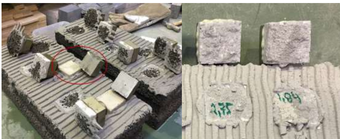
Figur 5.14 a och b. Figur (a) illustrerar brott mellan dragglack, lim och naturstensplatta för Norrvange kalksten. Notera inringad dragglack och natursten med röd cirkel. Figur (b) illustrerar närbild av brott delvis mellan betongplatta och fästmassa för Ice green.
