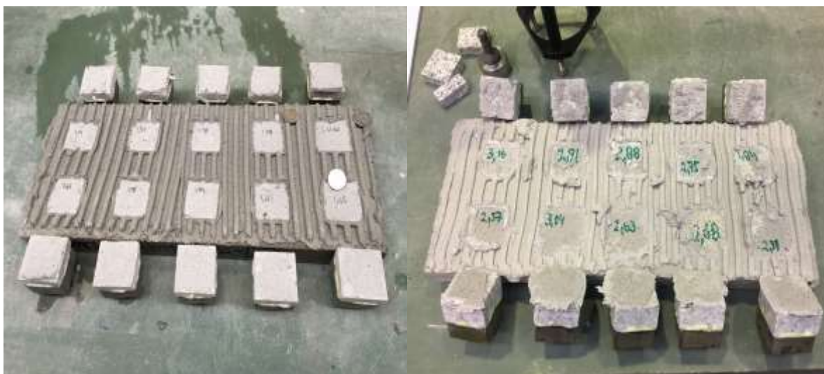
Figur 5.13 a och b. Figur (a) illustrerar brott i fästmassan och delvis i kontakten till underliggande betongplatta. Ett liknande scenario kännetecknar Ice-green (b).
