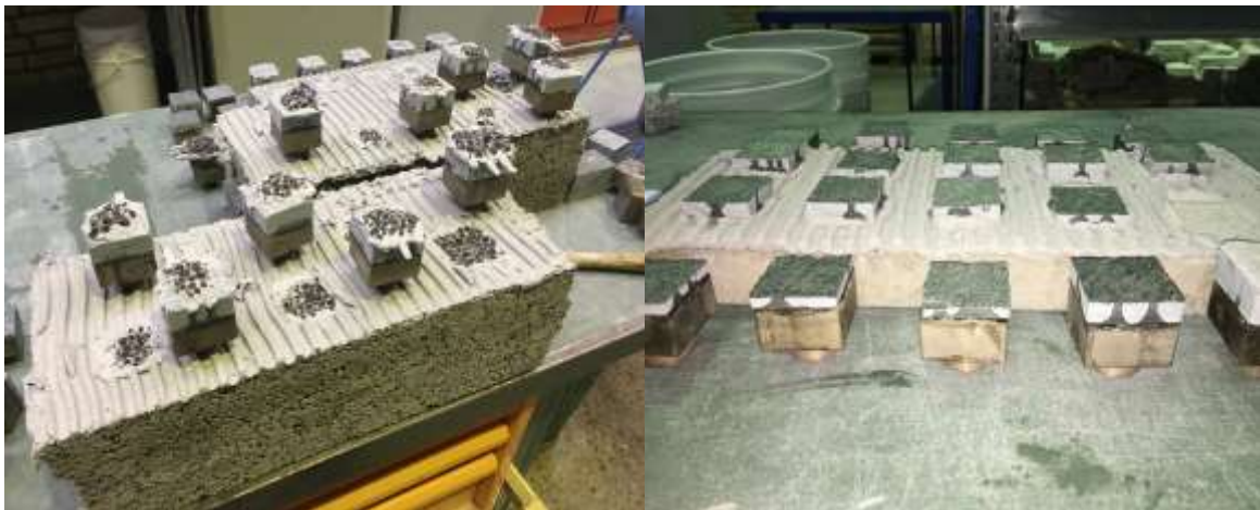
Figur 5.12 Fotot visar olika brottkriterier mot underlaget. Figur (a) där underlaget har givit vika och brottet skett i underlaget, figur (b) där spjälkning i skiffer är den dominerande orsaken till brott.
