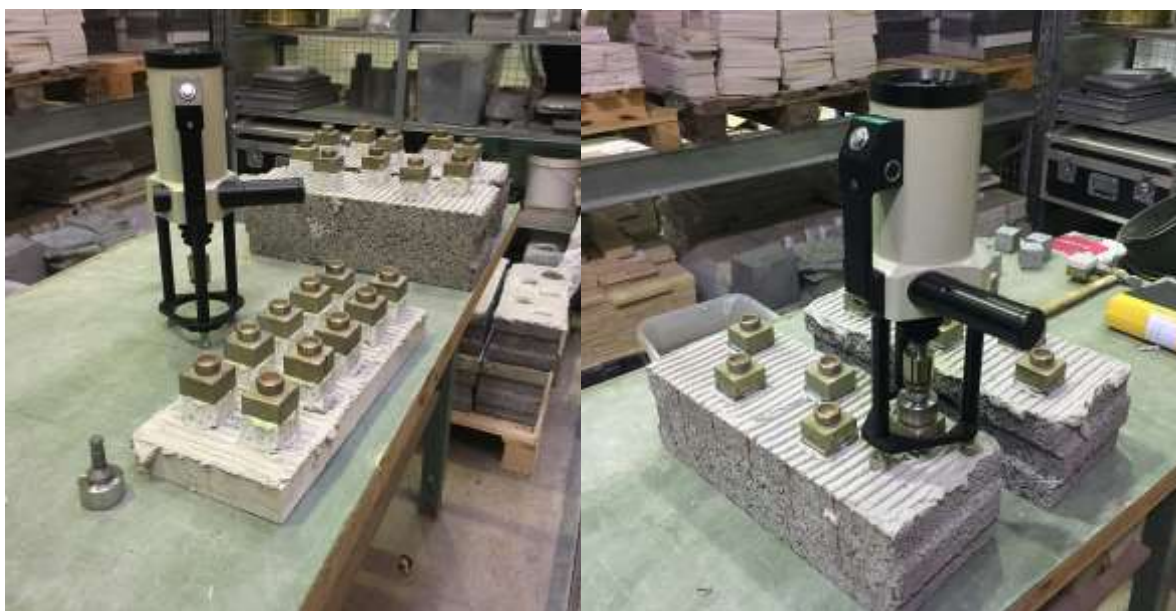
Figur 5.9 a och b. Figur (a) illustrerar förberett provmaterial av Ice green med monterad dragklack inför provdragning. I vänster framkant den skruvanordning som skruvas mot dragklack och fästs in i provdragarens centralaxel. Figur (b) visar initierad provdragning av diabas.
