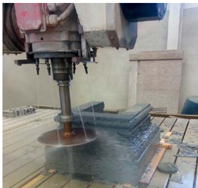
Vår moderna 6-axliga CNC-utrustning formar avancerade stendetaljer.
