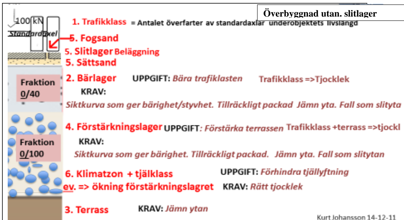
Fig. 3. Överbyggnaden, exklusive slitlager. De olika lagrens funktion/uppgift och kraven på dem. Materialskiljande lager mellan de olika lagren ej inritad
