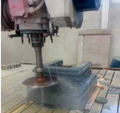
Vår moderna 6-axliga CNC-utrustning formar avancerade stendetaljer.
