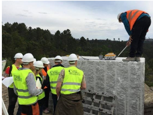
Figur 19. Demonstration av 800 MHz antennen.
