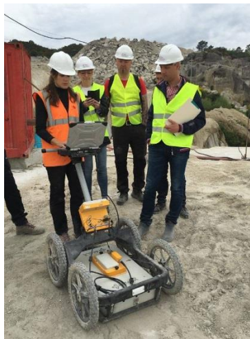
Figur 20. Demonstration av 250 MHz antennen.
