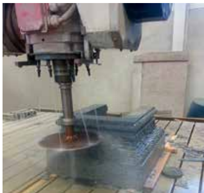
Vår moderna 6-axliga CNC-utrustning formar avancerade stendetaljer.
