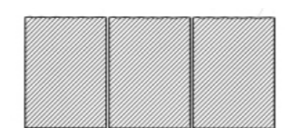
Fig 5. Blockstensmur/enskiftesmur. Ett enda horisontellt skift.
