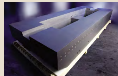
Bassten Prex 10. Maskinfundament 3930 x 1600 x 500mm i Brännhultsdiabas. Ovsidan plan på 0,004 mm, sidorna planare inom 0,004 mm parallella inom 0,01 mm.
