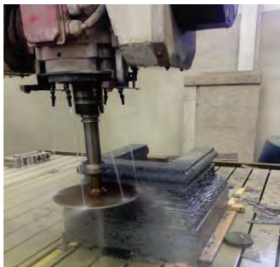
Vår moderna 6-axliga CNC-utrustning formar avancerade stendetaljer.
