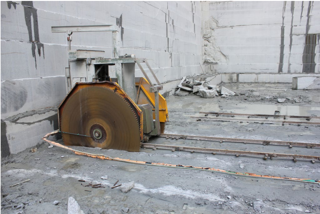
I detta brott i Kina sågar man i stor utsträckning fram blocken. Det förefaller rationellt, men processen kräver mycket elenergi som här till största delen produceras av kolkraftverk med hög klimatpåverkan.
