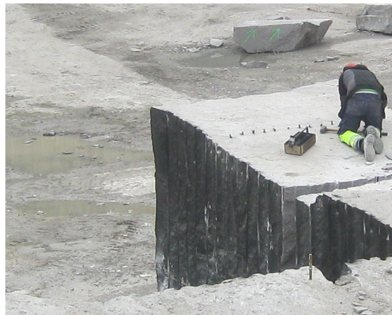
Vid brytningen i Bjärlövbrottet i Sverige utnyttjas de goda klyvegenskaperna hos berget. Med korta borrhål och kil kan stora volymer berg kilas fram med mycket små energinsatser och låg klimatpåverkan.
