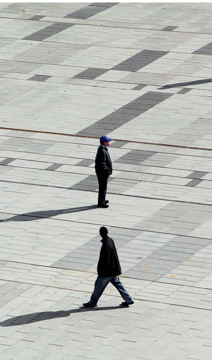
Vävmönstret på Stortorget i Gävle – som fick Sienapriset 2011 och Stenpriset 2013 – har skapats genom kombination av natursten i olika färgnyanser: Brännhult diabas, Flivik mahogany och Bohus grå tossene.
