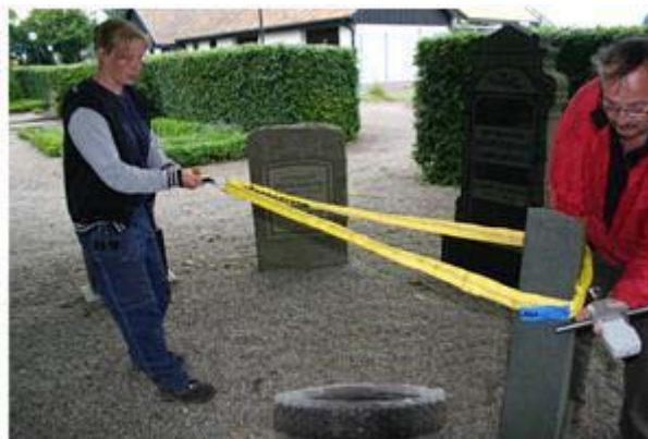
Figur 9. Belastningstest: fjädervåg, lyftstroppslinga och fender, här i form av bildäck.
