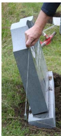
Figur 11. Vinkelmätning med lod.
