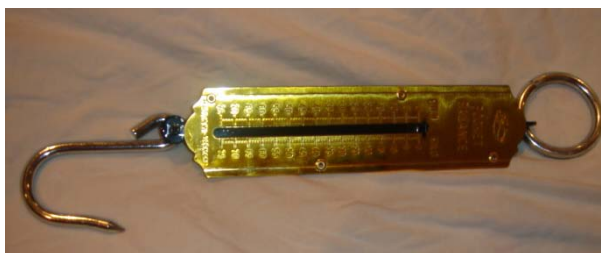
Figur 18. Fjädervåg för max 75 kg (750N)
