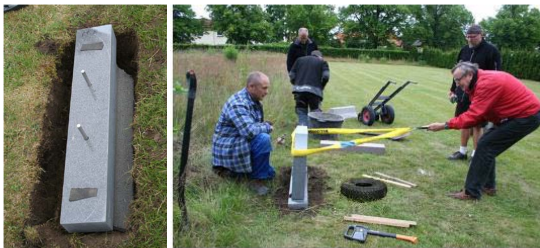
Figur 25 och 26. Gro-sockeln med synlig sockel. Stabilitetskontroll av montaget på GRO-sockeln.
