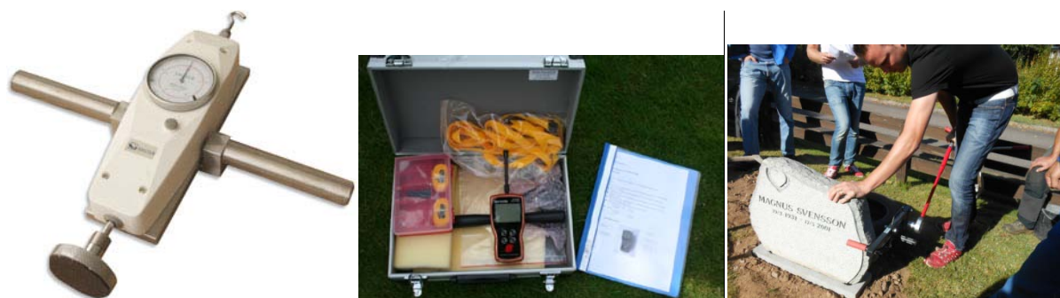
Figur 19. Tre gravstensinstrument. Till vänster FA-500 G från Elastocon AB, Brämhult, i mitten Sauturs instrument komplett i väska och med handledning på svenska, från SweTest, Saltsjö-Boo, Båda med tydlig display, tryckplatta och dragkrok och till höger det av Orax speciellt framtagna instrumentet för provning av gravstenssäkerhet.
