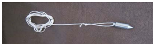
Figur 10. Ett enkelt lod att användas vid kontroll av lutning.
