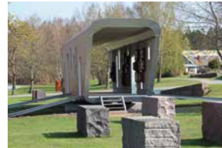
Runt ”järnvägsvagnen” har lagts handelsblock från olika svenska granitbrott där varje block getts fyra olika ytbearbetningar: råkilad, krysshamrad, flammad och polerad. Foto Jimmy Ek
