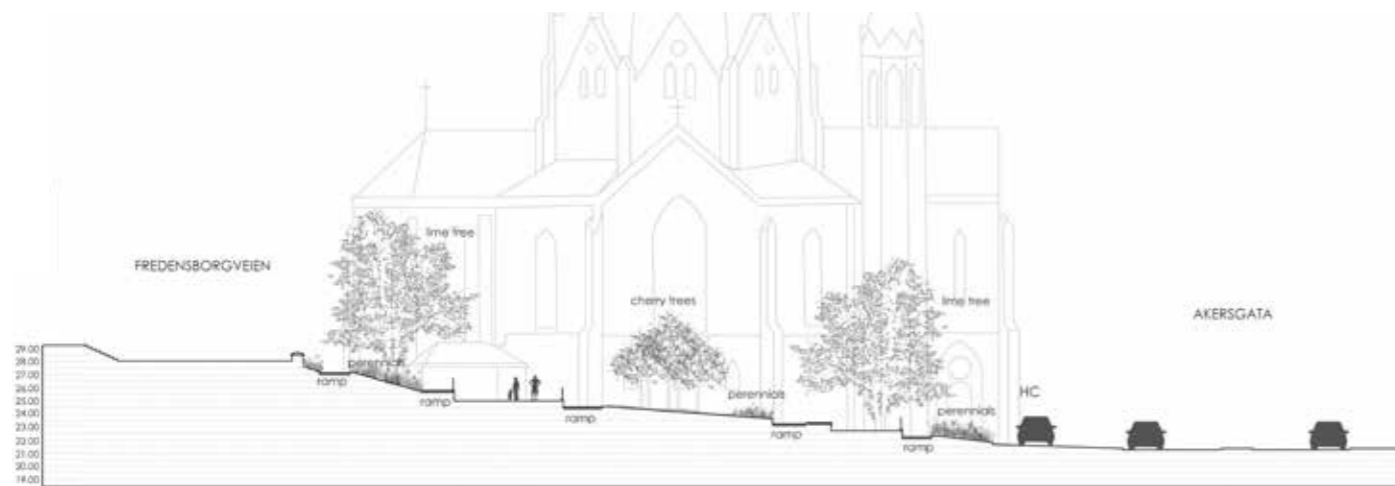
Plassen tar trinnfritt opp 7 meter høydeforskjell mellom Fredensborgveien og Akersgata.
