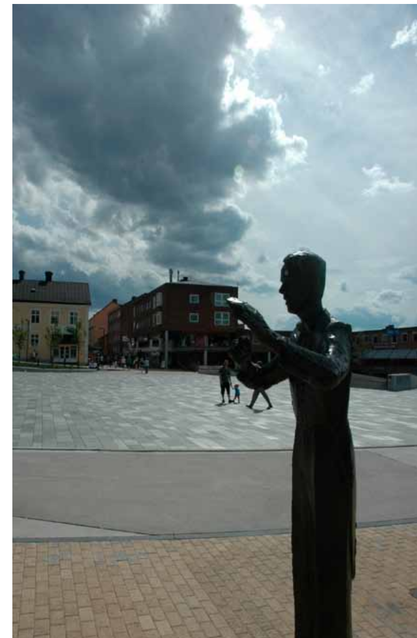
Konstverket "kören" fick ny placering framför Storsjöteatern. Närmast skulpturen ser vi den gyllene betongstenen, därefter ligger ljusgrå markbetong. Denna skapar en gränsszon mellan den gyllene stenen och den centrala delens skifferyta. Skifferns uttryck varierar på ett vackert sätt genom ljusets skiftningar. Vid regn blir ytan nästan svart. Foto: Robert Kjellén
