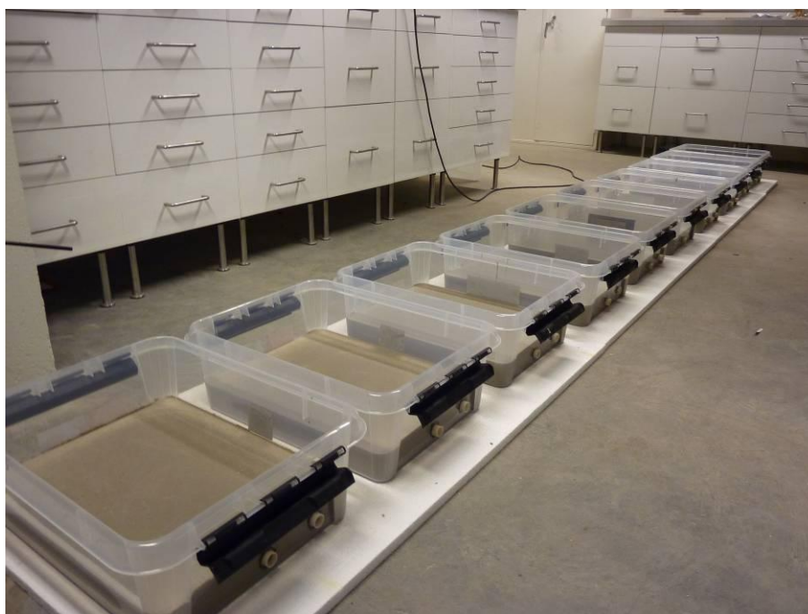
Bild 1: Försök 1 bestod av 10 plastbackar med dimension 300x400 mm 2 avjämnade med 50 mm normaltorkande avjämning.
