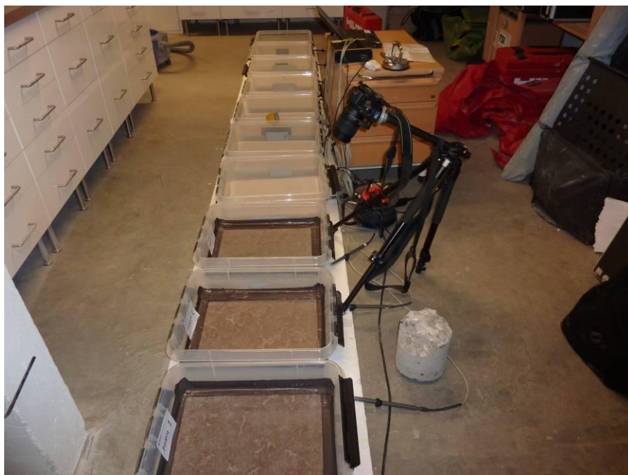
Bild 2: Stenbeläggning lades med en veckas mellanrum. Relativ fuktighet i provkropparna loggades kontinuerligt.
