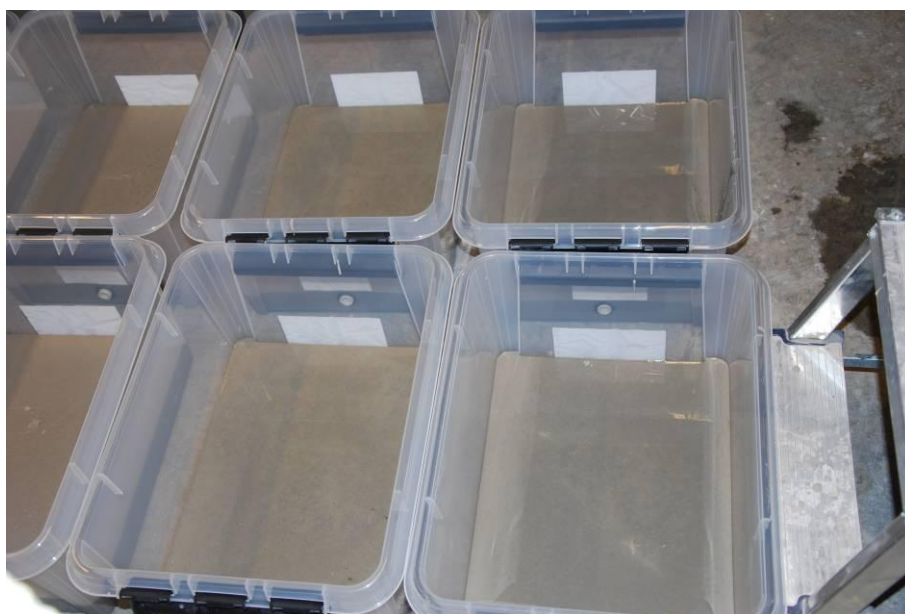
Bild 3: Totalt har 40 formar avjämnats med en skikttjocklek på 50 mm.
