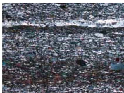
Fig 3.7 Kvartsitskiffer, tunnslip. Kvarts, fältspat och glimmer har parallellstruktur och bildar en utpräglad skiffrihet. Verklig storlek: längd 5,5 mm.
