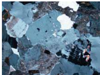
Fig 3.6 Granit, tunnslip. Består av huvudmineralen kvarts, glimmer och fältspat (inklusive pyroxen). Verklig storlek: längd 5,5 mm.
