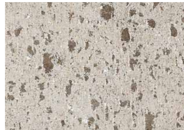
Fig 7.12 Normalhyvlad, gråbrun kalksten. Nyhyvlad, skala 1:1
