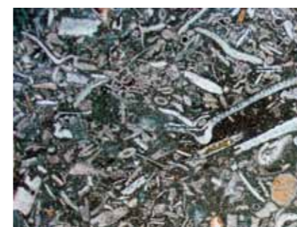
Fig 3.12 Kalksten, tunnslip. Kalkspat med finkornig textur och skalfragment. Verklig storlek: längd 5,5 mm.
