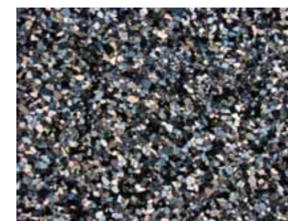
Fig 3.14 Silikatbunden sandsten, tunnslip. Kornen är kvarts. Bindemedlet silikat. Verklig storlek: längd 5,5 mm.
