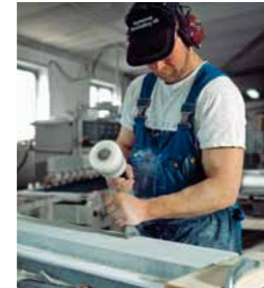
Fig 7.3 Lågerhuggning av kalksten med klubba och mejsel
