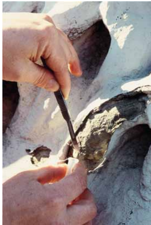
Fig 4.23 Provtagning på sandsten som bemålats. Stenen är i dåligt skick, med resultat att den vittrat under färgskiktet.
