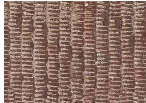
Fig 7.11 Tandhuggen, röd kalksten. Nyhuggen, skala 1:1
