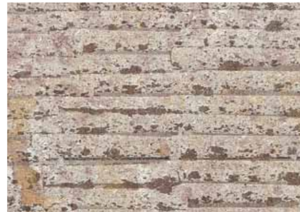
Fig 7.10 Läghuggen, gråbrun kalksten. Nyhuggen, skala 1:1
