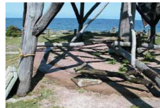
Fig 7.2 Skurkvarn, Jordhamn, Öland, för slipning, "skurning" av kalkstensplattor. En platta dras runt över en cirkel med plattor. Sand och vatten slipar
