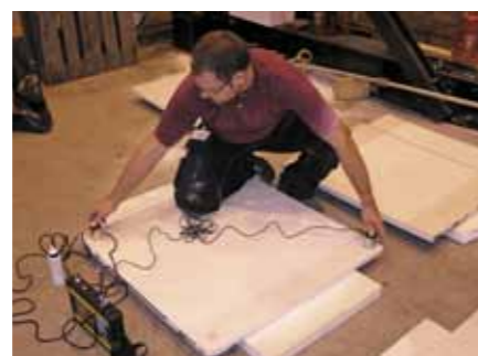
Mätning av ultraljudshastighet i laboratorium
